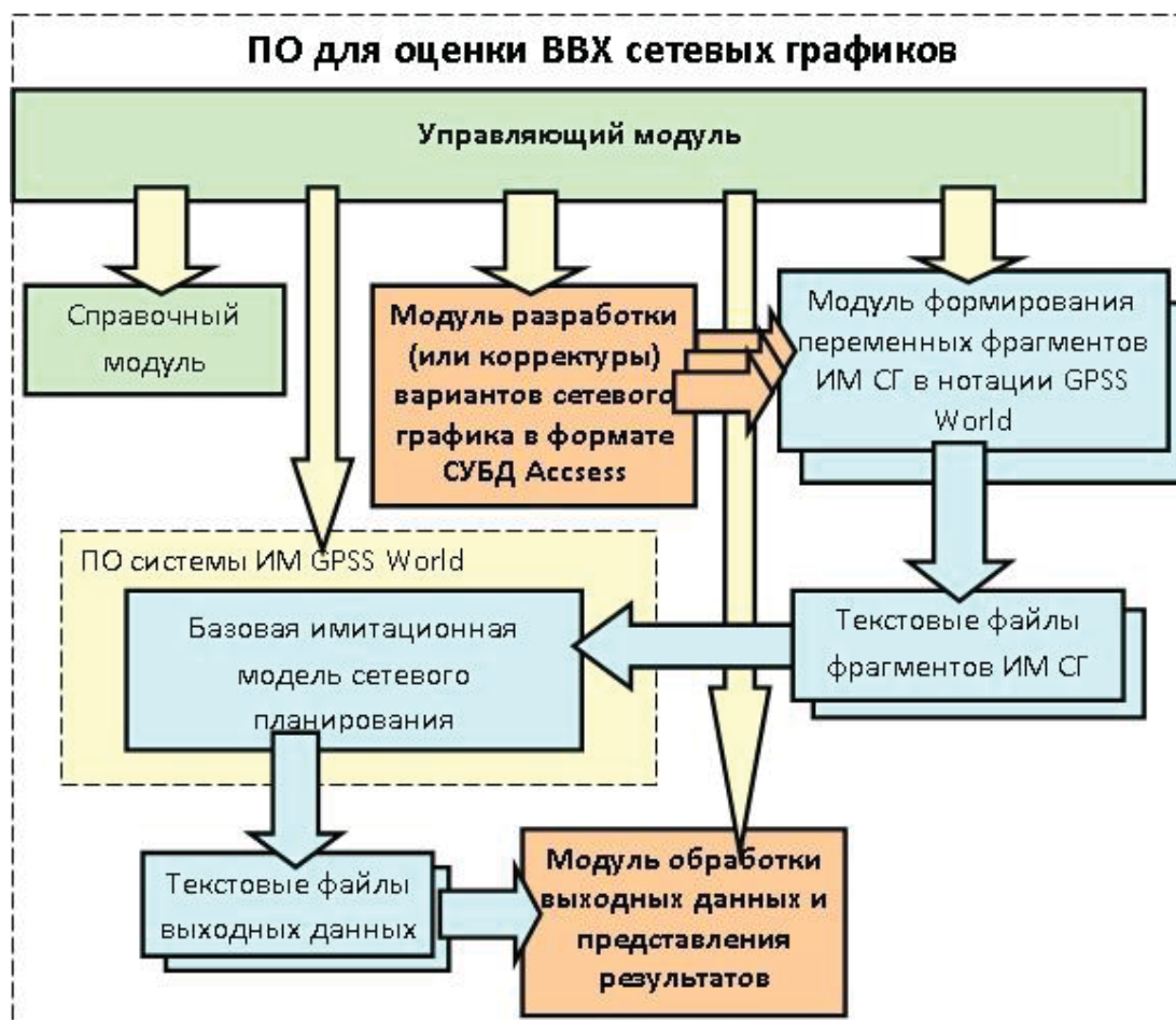
Рис. 1. – Блок-схема архитектуры программного средства оценки ВВХ и стоимости процессов управления проектами
