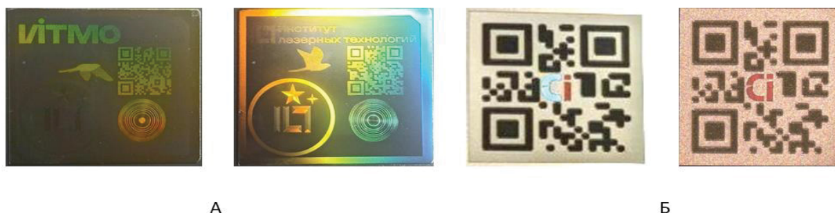
Рисунок 2 – Примеры уникальных защитных меток на поверхности стали (А) и титана (Б), записанных по технологии цветной лазерной маркировки. Цвет и / или форма изображения изменяются при рассмотрении под разными углами
